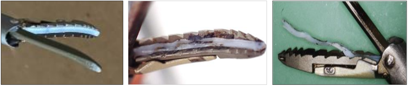
図2. 正常なティシューパッド (左)、変形したティシューパッド (中央)、剥がれたティシューパッド (右)
