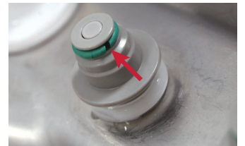
破損の例：リング状ゴムが切れている
