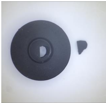
図1. MAJ-210 スリット部のゴムの破断
